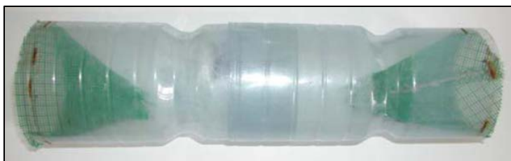
Slika 15. Ručno izrađena vrša od PVC boce i plastične mreže
